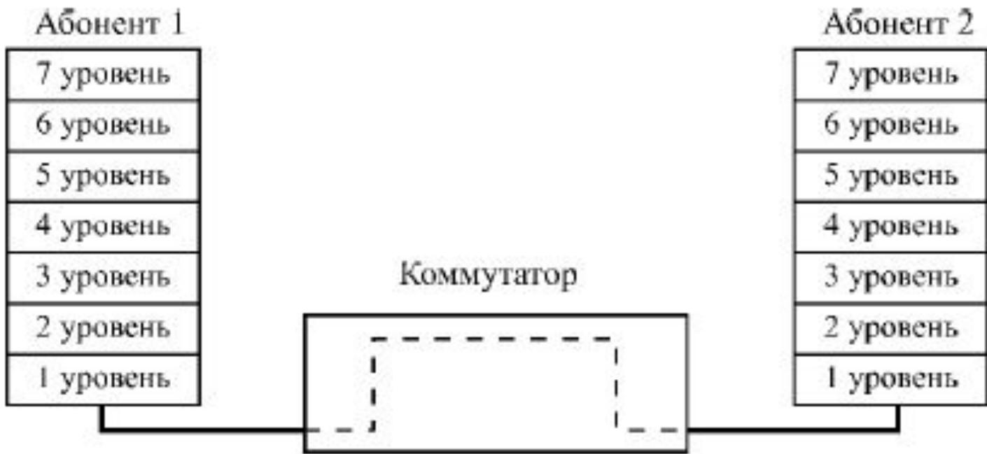
Рис. 5.10. Функции коммутаторов в модели OSI
