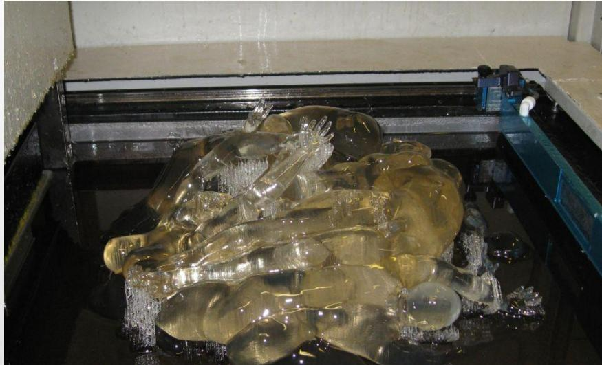
В качестве фотополимера используется полупрозрачный материал, который деформируется под действием атмосферной влаги.
