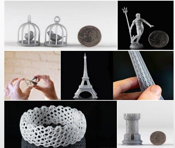
После отвердевания он легко поддаётся склеиванию, механической обработке и окрашиванию. Рабочий стол (элеватор) находится в ёмкости с фотополимером. После прохождения через полимер лазерного луча и отвердения слоя рабочая поверхность стола смешается вниз.
