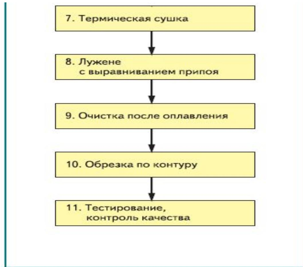
Рисунок 3 – Упрощённая схема изготовления одно- и двусторонних гибких печатных плат без металлизации отверстий
