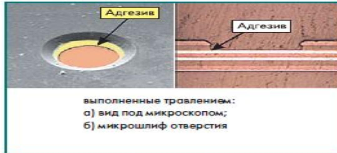
Рисунок 7 – Отверстия в покровном слое, выполненные травлением
