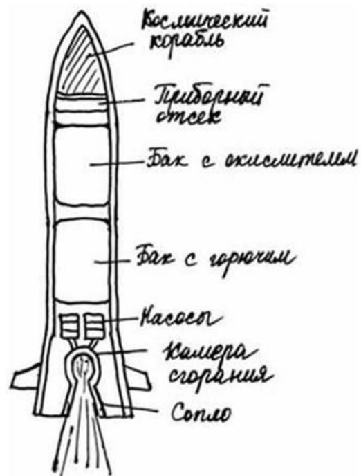
Устройство одноступенчатой ракеты
