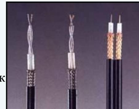
❖ **витая пара** – наиболее дешевое кабельное соединение. Позволяет передавать информацию со скоростью до 10 Мбит/сек. Но длина кабеля не может превышать 1000 м уже при скорости передачи 1 Мбит/сек. Для повышения помехозащищенности информации часто используют экранированную витую пару, т.е. витую пару, помещенную в экранирующую оболочку, подобно экрану коаксиального кабеля.
