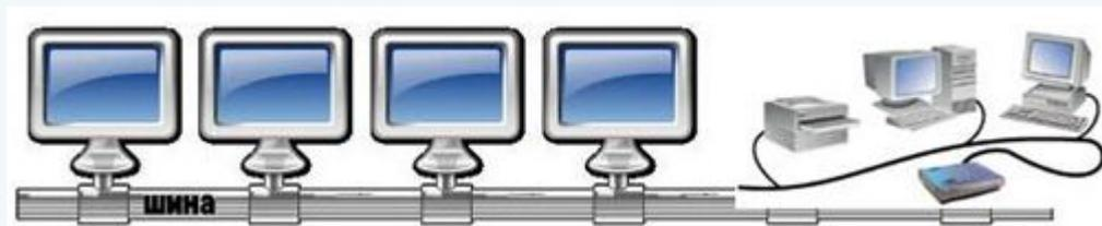
**Шина** – кабель проходит от одного компьютера к другому, соединяя компьютеры и периферийные устройства.
