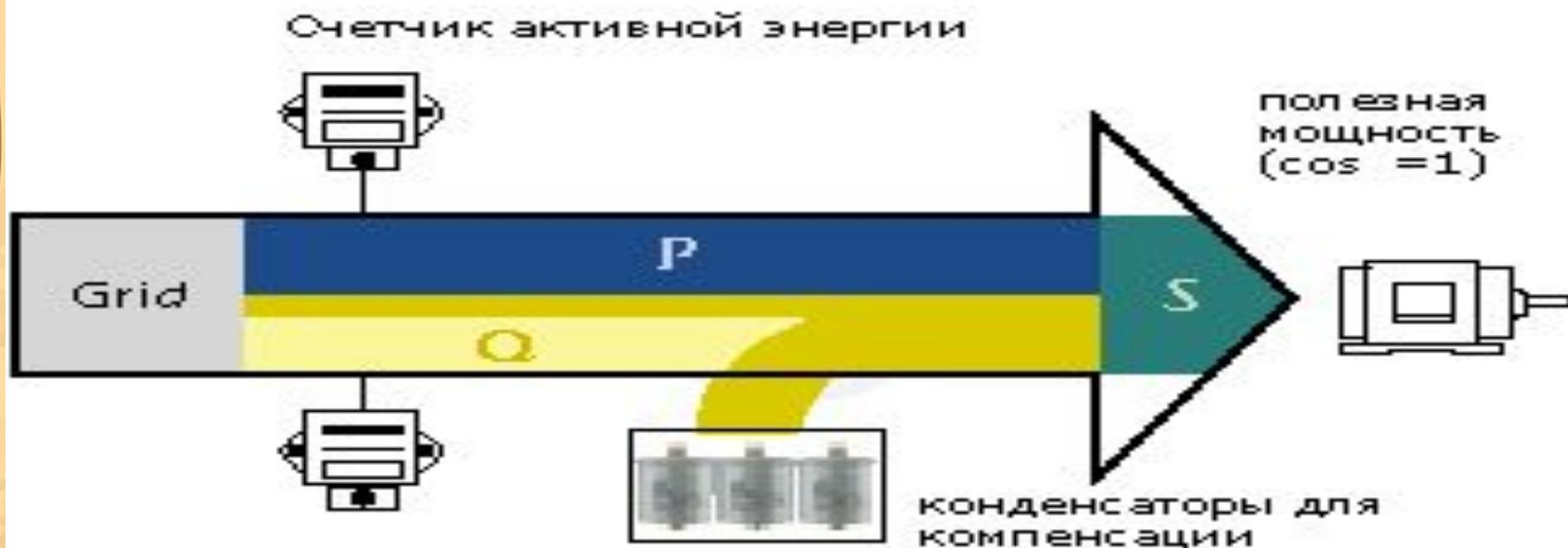
Уменьшение реактивной нагрузки позволит производителю электроэнергии при той же величине производимой мощности снабжать дополнительных потребителей, то есть обеспечить в определенной степени прирост потребления без увеличения вырабатываемой мощности. Или потребителю прирастить свои производственные мощности без увеличения потребления из сети.
