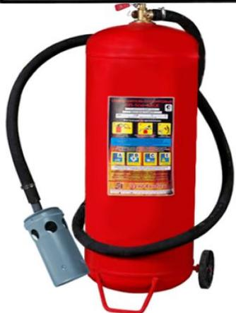
Если работа ведется с передвижными огнетушителями, то реактивное воздействие струи становится сильнее с увеличением давления в корпусе огнетушителя. При этом маневрировать устройством становится сложнее. Так же на это влияет и размер диаметра выходного отверстия насадки-распределителя.
