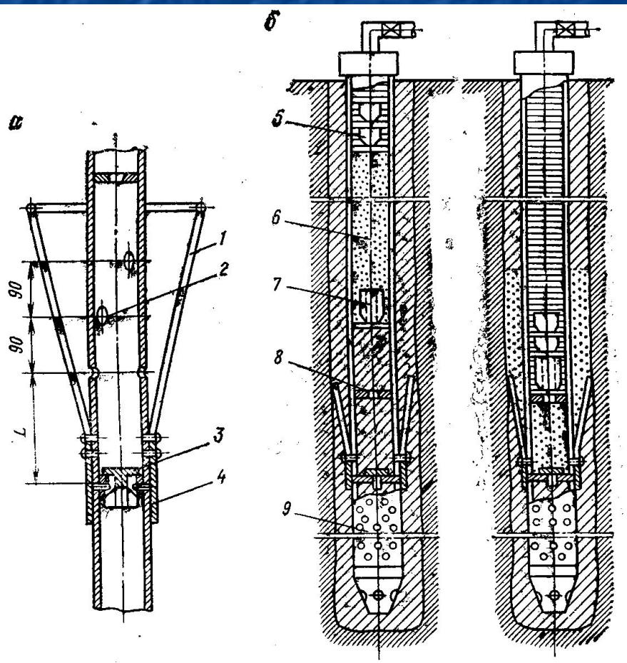
РИС. 4. Схема манжетного цементирования
