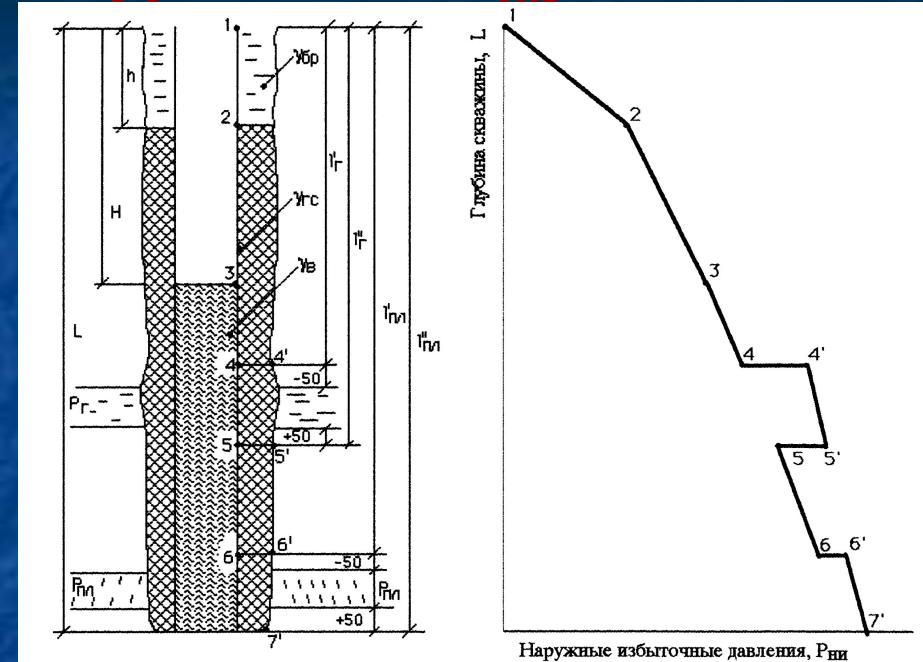
Изменение давления по глубине между расчётными точками принимается прямолинейным. Пример такого графика и соответствующей схемы при вызове притока снижением уровня приведён на рисунке:
