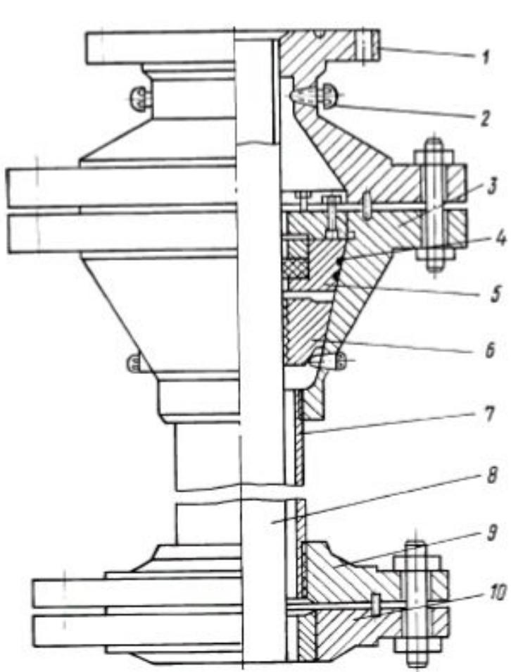
Рис. 5.1. Колонная головка клиновая типа ГКК:
