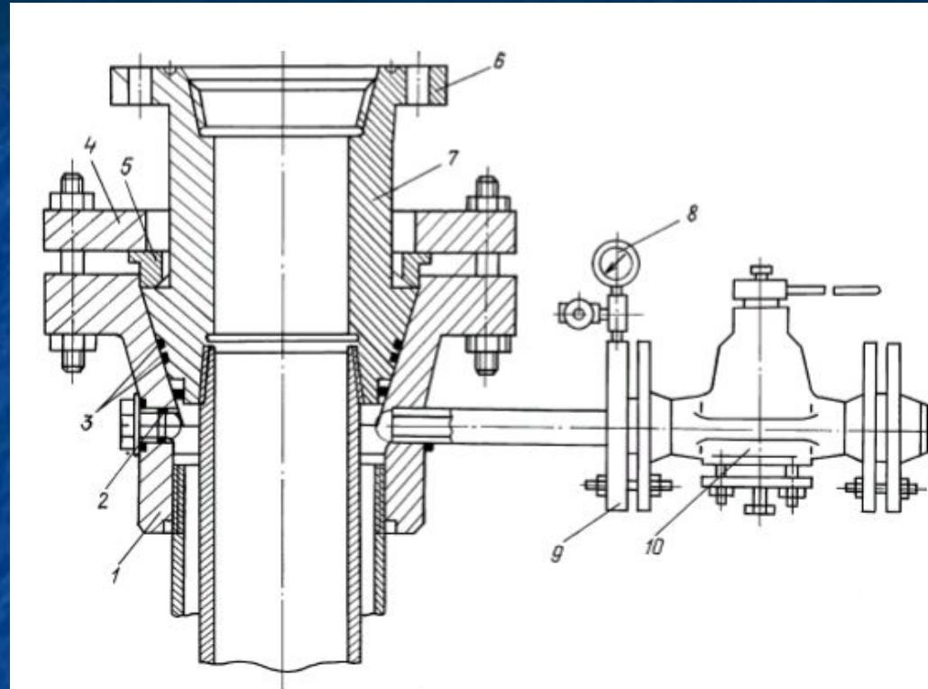
Рис. 5.2. Головка колонная муфтовая типа ГКМ:
