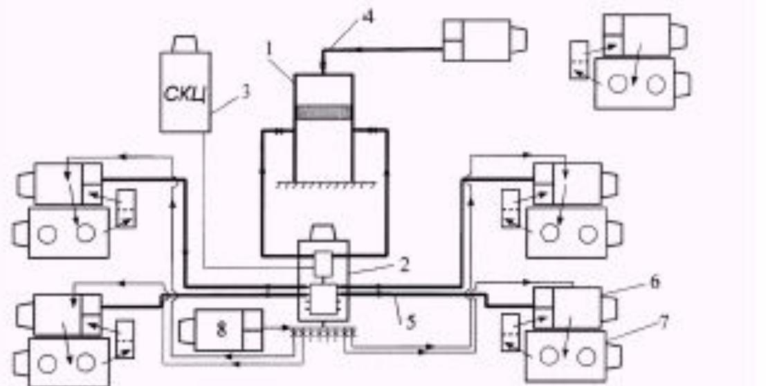
1 - цементировочная головка; 2 - блок манифольдов; 3 - станция контроля цементирования;
