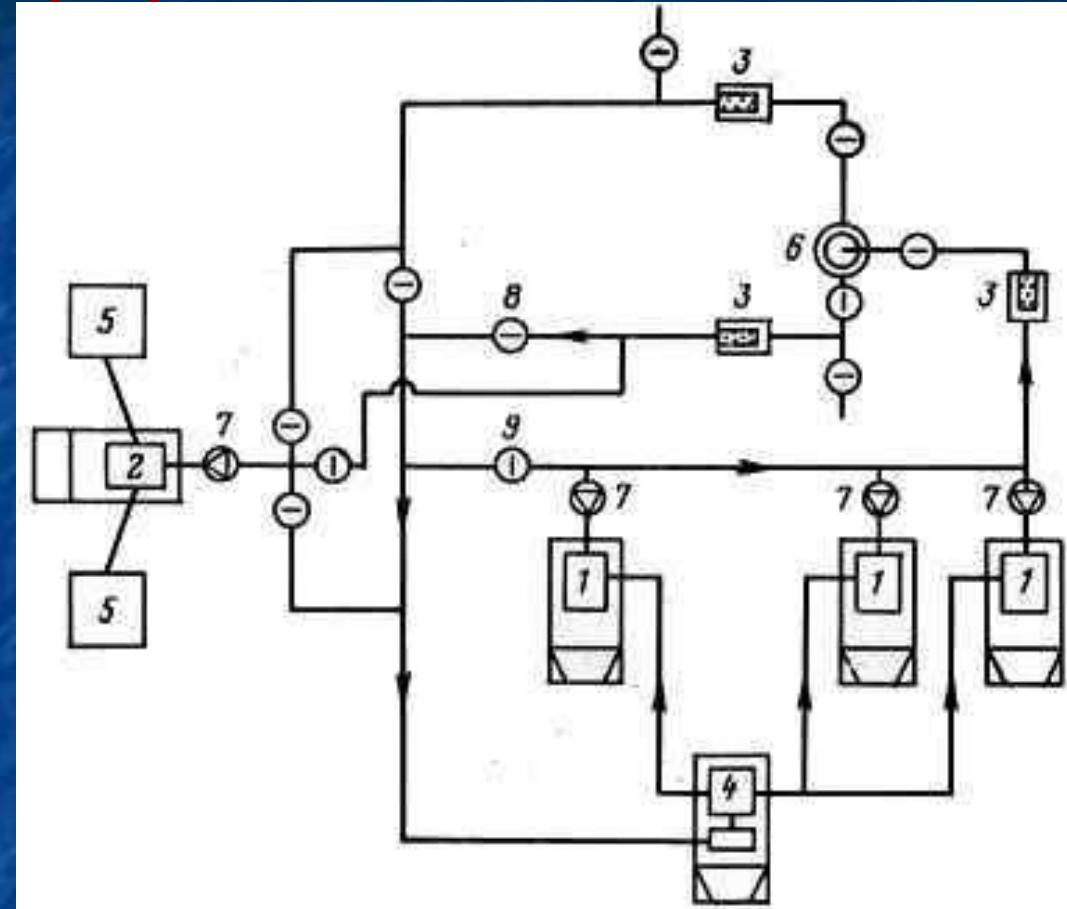
**Схема обвязки поверхностного оборудования при работе по замкнутому циклу:** 1 - АН-700; 2 - ЦА-320; 3 - шламоуловитель; 4 - пескосмеситель; 5 - емкость; 6 - скважина; 7 - обратный клапан; 8 - открытые краны; 9 - закрытые краны
