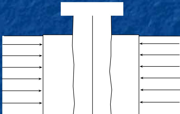
*Схема притока в скважину, несовершенную по качеству вскрытия*
