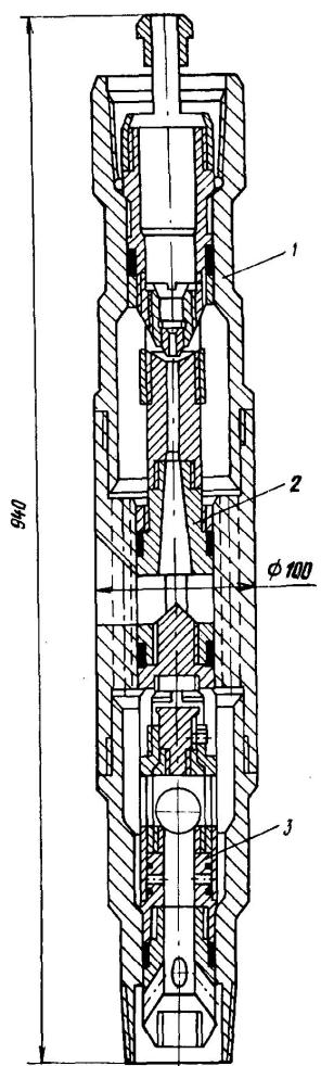
Схема размещения струйного аппарата в скважине предполагает его установку в колонне НКТ с пакером.
