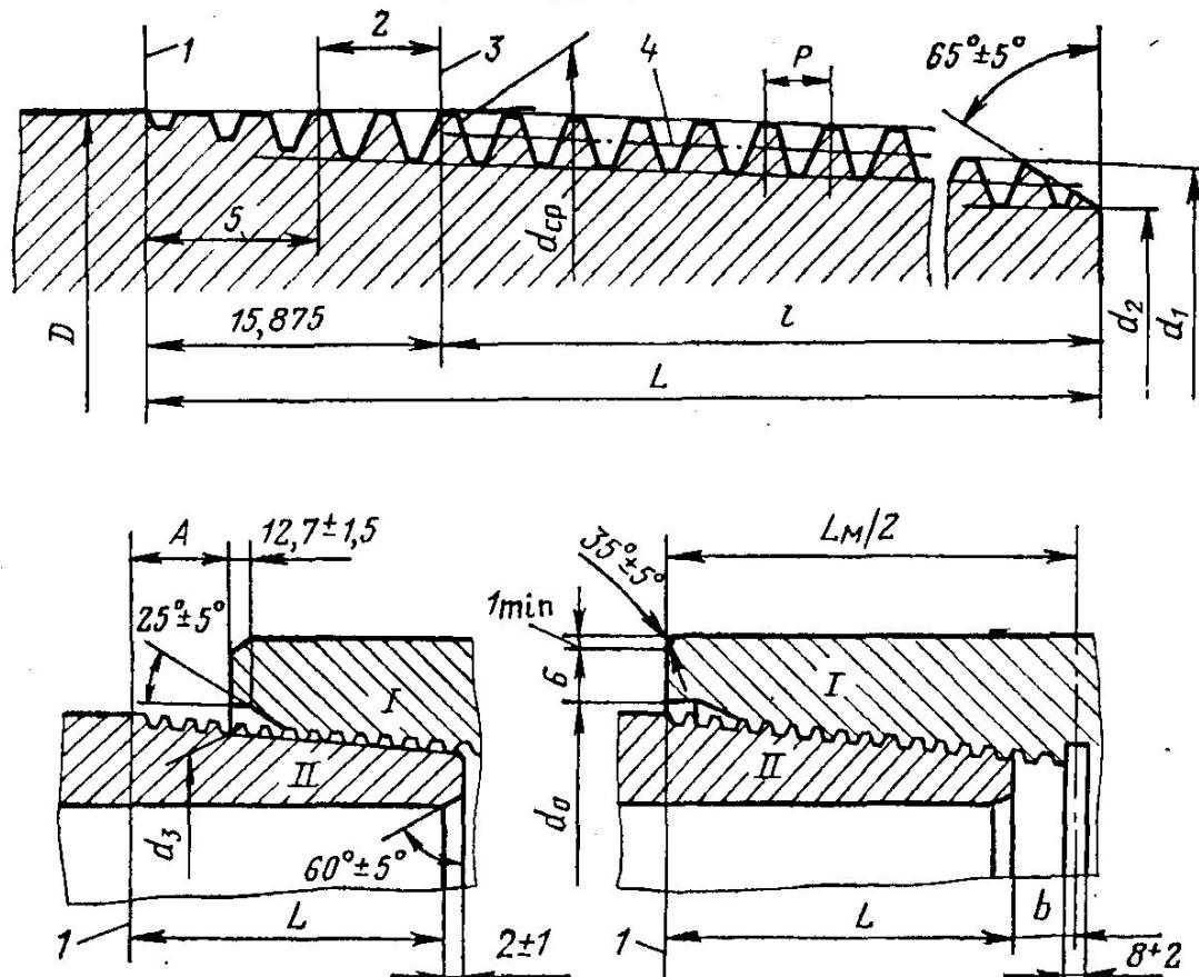
Размеры соединений с треугольной резьбой:
