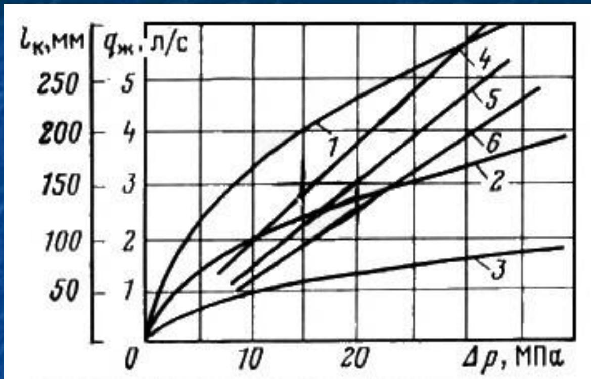
Зависимость расхода водопесчаной смеси  $q_{ж}$  и глубины образующихся каналов  $l_k$  от перепада давления  $\Delta P$  в насадке для трех ее диаметров 3; 4,5 и 6 мм:
