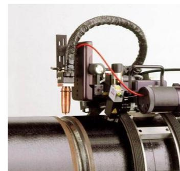
**Сварочный комплекс** для автоматизации сварки неповоротных стыков трубопроводов
