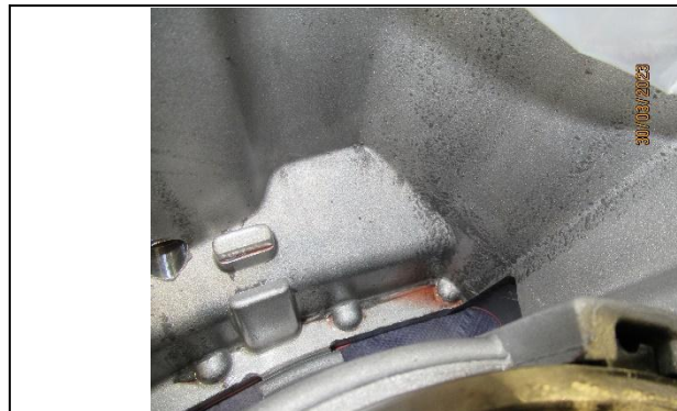
Стружка и продукты износа на стенках корпуса АКПП
