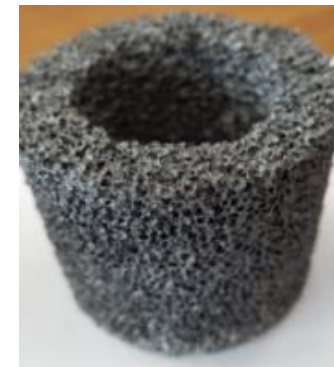
Исходный ППУ и контактные элементы различной формы и плотности пор
