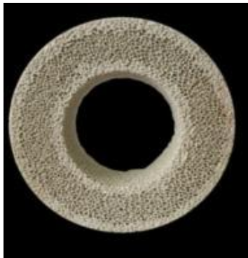
Исходный ППУ и контактные элементы различной формы и плотности пор
