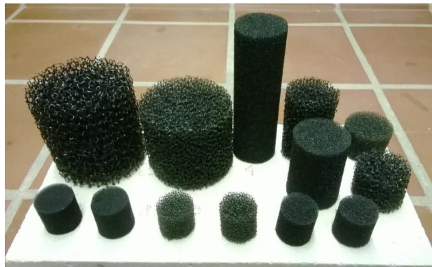
Исходный ППУ и контактные элементы различной формы и плотности пор
