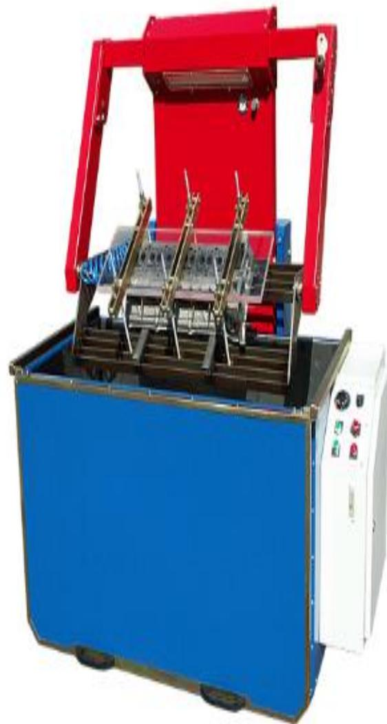
Установки для опрессовки ГБЦ позволяют диагностировать проблемные зоны двигателей. Принцип работы оборудования заключается в проверке узлов на герметичность с применением сжатого воздуха в водной среде. Деталь герметизируется и погружается в камеру с водой, в одно из отверстий подается сжатый воздух под давлением. Наличие пузырьков воздуха свидетельствует о наличии трещин в оборудовании
