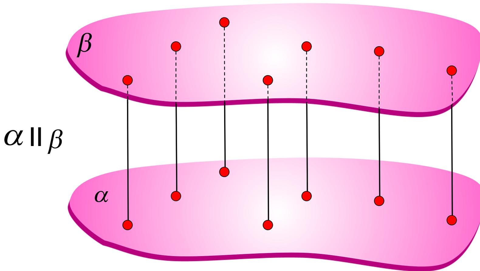
Расстояние от произвольной точки одной из параллельных плоскостей до другой плоскости называется **расстоянием между параллельными плоскостями.**
