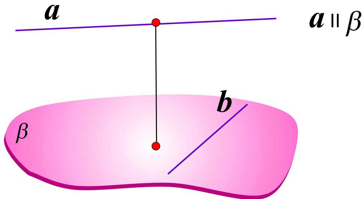
Расстояние между одной из скрещивающихся прямых и плоскостью, проходящей через другую прямую параллельно первой, называется **расстоянием между скрещивающимися прямыми**.
