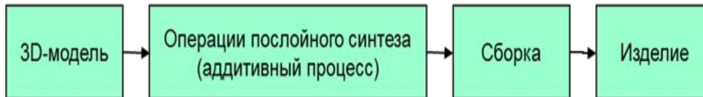
FDM (Fused deposition modeling) — послойное построение изделия из расплавленной пластиковой нити. Это самый распространенный способ 3D-печати. FDM-принтеры работают с различными типами пластиков, самым популярным и доступным из которых является АРС
