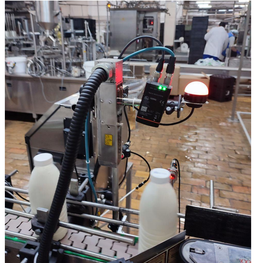
Комплекс маркировки (принтер и камера), установленные на линии розлива молока в бутылки
