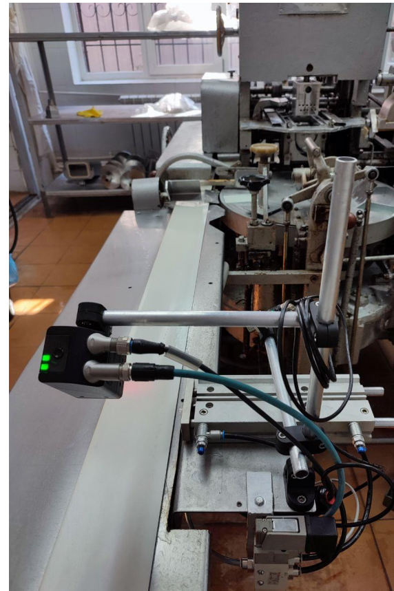
Комплекс маркировки (принтер и камера) установленные на линии фасовки масла
