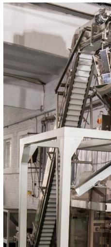
Фасовочное оборудование: транспортер ковшовый, упаковочный автомат SBI-200M (Русская Трапеза) – фасовка в пакеты с проваренными гранями, мультиголовочный дозатор
