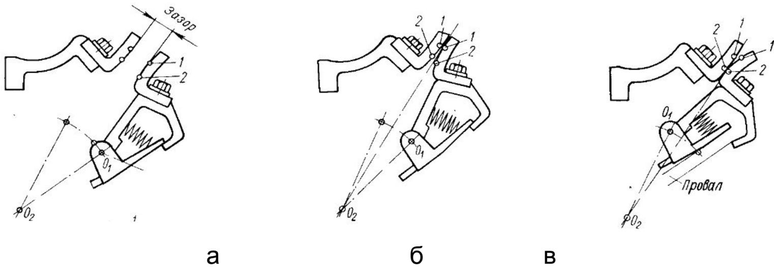
Рисунок 4.2 – Кинематика движения контактов при замыкании
