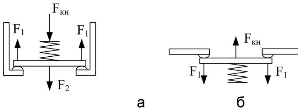
Рисунок 4.1 – Примеры электродинамической компенсации ЭДУ при КЗ
