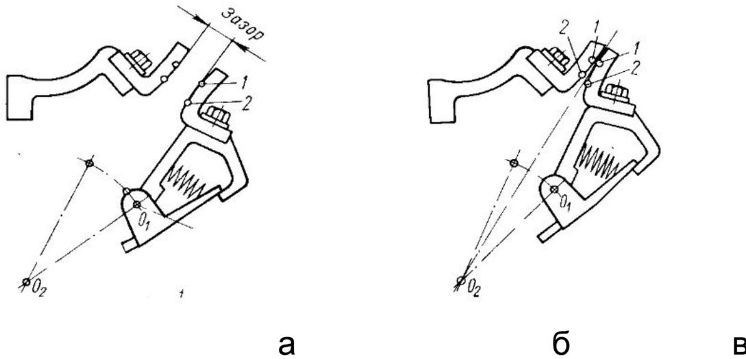
Рисунок 4.2 – Кинематика движения контактов при замыкании
