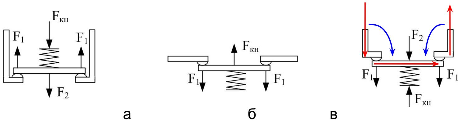
Рисунок 4.1 – Примеры электродинамической компенсации ЭДУ при КЗ
