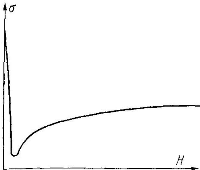
Рисунок 4.3 – Зависимость износа от напряженности магнитного поля
