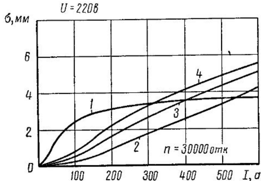
Рисунок 4.4 – Зависимость износа от тока в дуге
