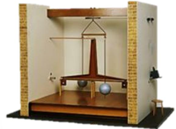
Измерив силу взаимодействия между шарами  $m$  и  $M$  по углу закручивания нити и зная массу шаров и расстояние между ними, Кавендиш определил гравитационную постоянную.
