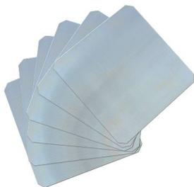
Поликристаллические - отличаются светло-синим цветом. Производятся посредством химического охлаждения расплавленного кремния, когда множество кристаллов затвердевают близко друг к другу в произвольном порядке.
