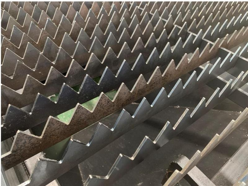
Стальной зубчатый стол выдерживает более тяжелые заготовки и имеет только небольшую площадь, чтобы касаться заготовки при резке, максимально увеличивая плавление поверхности стола под воздействием тепла лазера. Каждый элемент независим для легкой замены и обслуживания.
