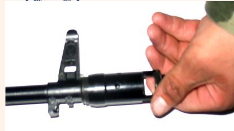
**Рис.5 Отсоединить дульный тормоз компенсатор, у РПК-74 отсоединить пламегаситель.**
