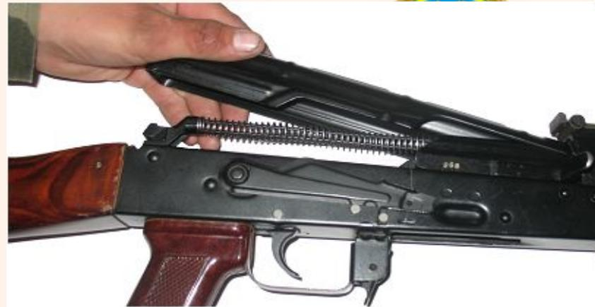
**Рис. 6 Отсоединить крышку ствольной коробки**
