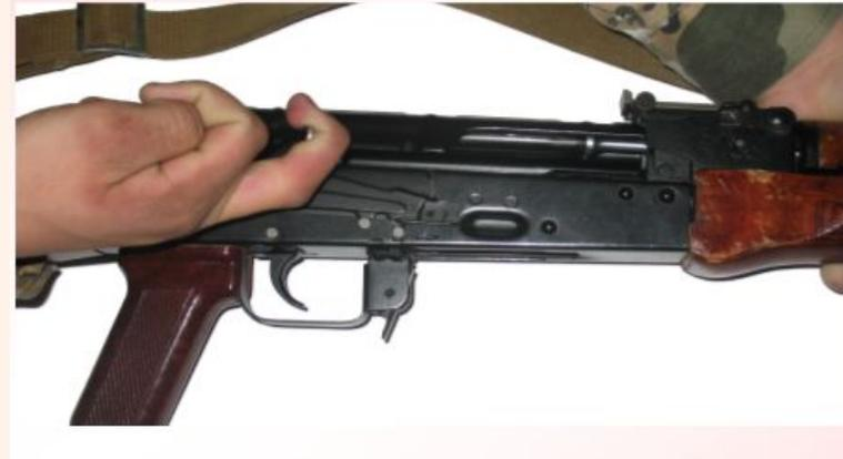
**Рис.2 Проверить оружие на разряженность**
