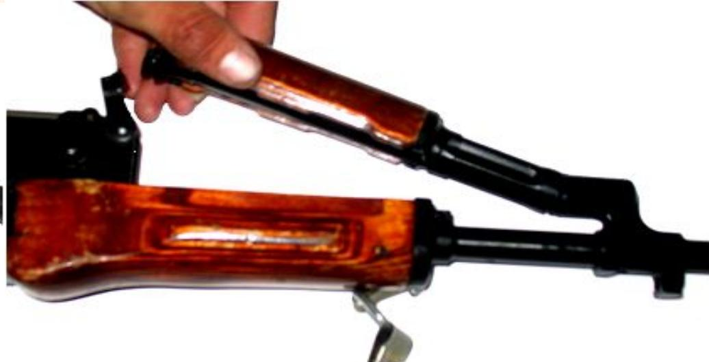
**Рис. 10 Отделить газовую трубку со ствольной накладкой**
