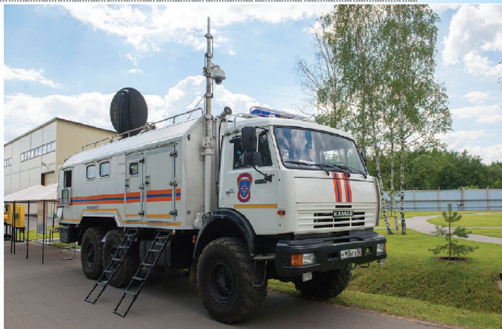
Подвижный пункт управления и связи для проведения аварийно-восстановительных работ
