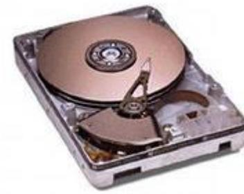
Накопитель на жёстких магнитных дисках или НЖМД, жёсткий диск, «винчестер» — запоминающее устройство (устройство хранения информации) произвольного доступа, основанное на принципе магнитной записи.
