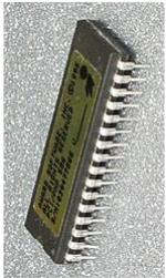
**BIOS** (Basic Input/Output System). BIOS записывают в микросхему постоянной памяти (ROM), которую устанавливают на системную плату компьютера (отсюда название - ROM BIOS). Такая память энергонезависима, а это гарантирует, что BIOS никогда не будет поврежден.
