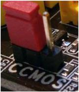
**CMOS** (название технологии, по которой производится микросхема: *Complementary Metal-Oxide-Semiconductor* - комплементарный металлооксидный полупроводник или КМОП).
