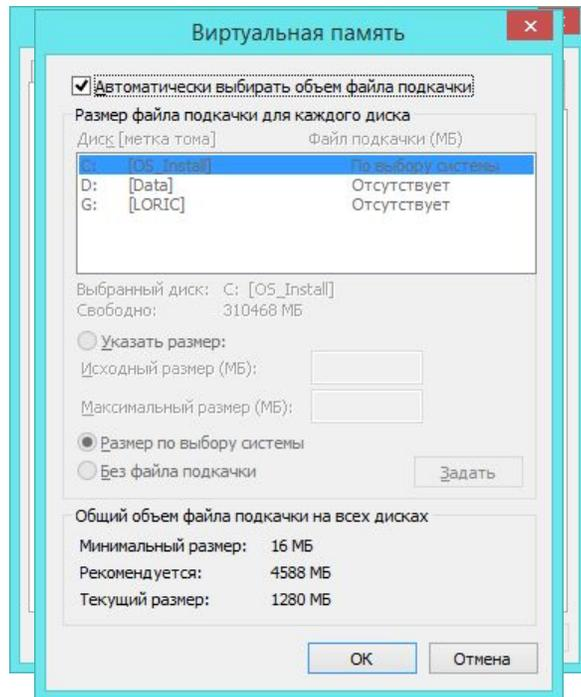
Для просмотра текущего размера файла подкачки в ОС семейства Windows – Свойства системы (sysdm.cpl).
