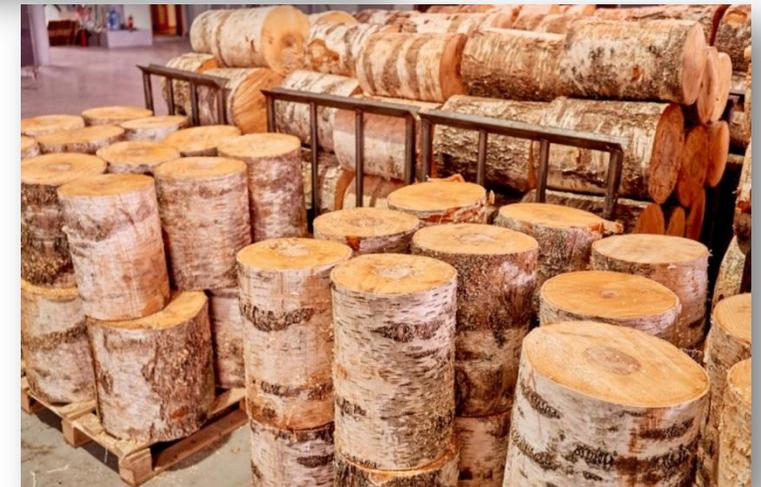
На этапе проходит контроль размеров чураков и контроль на возможное наличие пороков древесины
