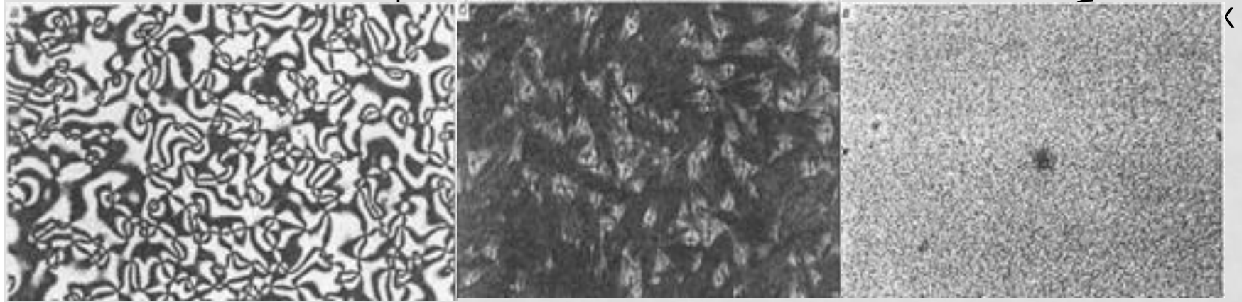
Рисунок 1.2- Типичные текстуры нематических(а), смектических(б) и холестерических (в) жидких кристаллов: а — шликрен, б — веерная, в — конфокальная текстуры
