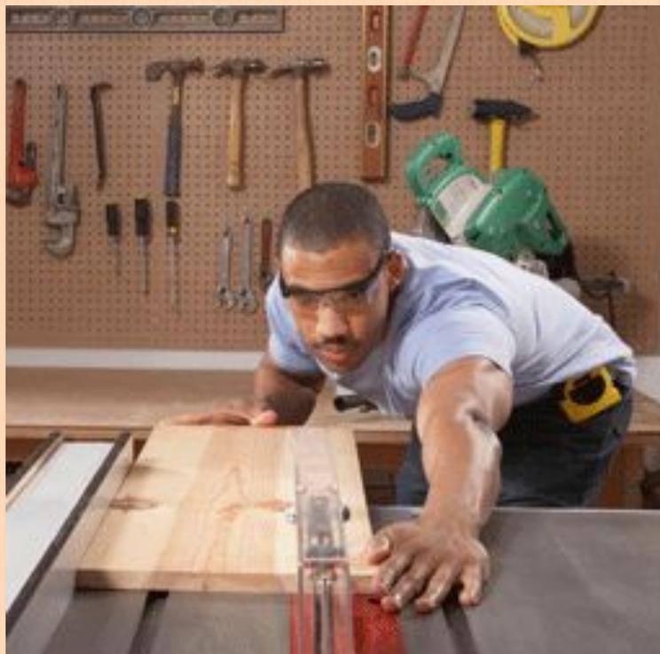
Станочник обрезных станков осуществляет продольный раскрой досок на обрезные доски различной ширины.
