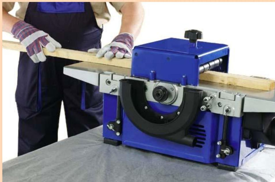
Станочник строгальных станков обслуживает фуговальные и рейсмусовые станки: строгает пласти и кромки брусков и досок, обрабатывает доски и бруски в размер по толщине, фугует прямолинейные кромки в пачках листов шпона.
