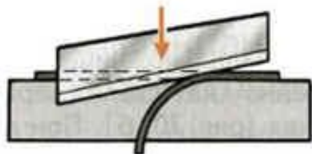
Резание толстолистого металла механическими ножницами.
