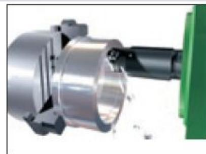
Использование сдвоенного инструмента с разворотом инструментального шпинделя под  $90^\circ$  в качестве расточной оправки.
