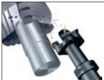
Точение с разворотом фрезерного шпинделя под углом  $0^\circ$ .
