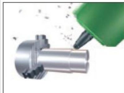
Точение и подрезка торца
