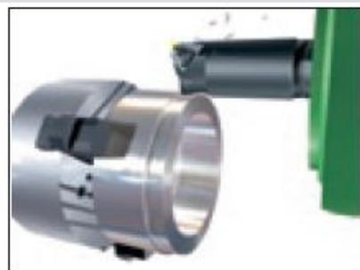
Точение с расположением инструментального шпинделя под углом  $0^\circ$ . Хороший вариант для станков с ограниченным перемещением по оси X.
