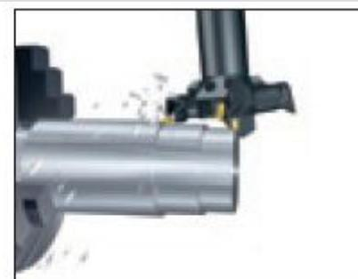
Точение с разворотом фрезерного шпинделя под углом  $95^\circ$ , чтобы режущие кромки головок, не участвующих в работе, не касались заготовки.
