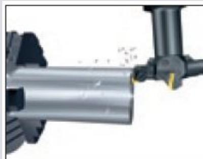
Точение с разворотом фрезерного шпинделя под углом  $95^\circ$ .
