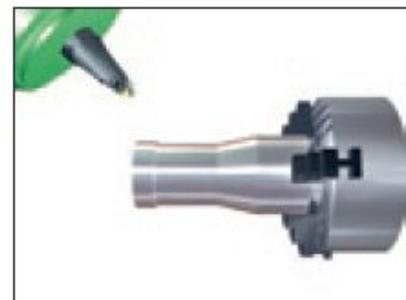
Точение по направлению к контршпинделю. Поворот инструментального шпинделя вокруг оси В и смена направления вращения детали.
