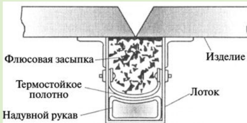
Рис. 7.26. Сварка на флюсовой подушке.
