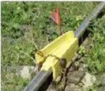
Устройства для предупреждения самопроизвольного выхода подвижного состава на маршруты следования поездов - предохранительные тупики, охранные стрелки, сбрасывающие башмаки, сбрасывающие острия или сбрасывающие стрелки, другие устройства, исключаящие самопроизвольный выход подвижного состава на другие пути и маршруты приема, следования и отправления поездов
