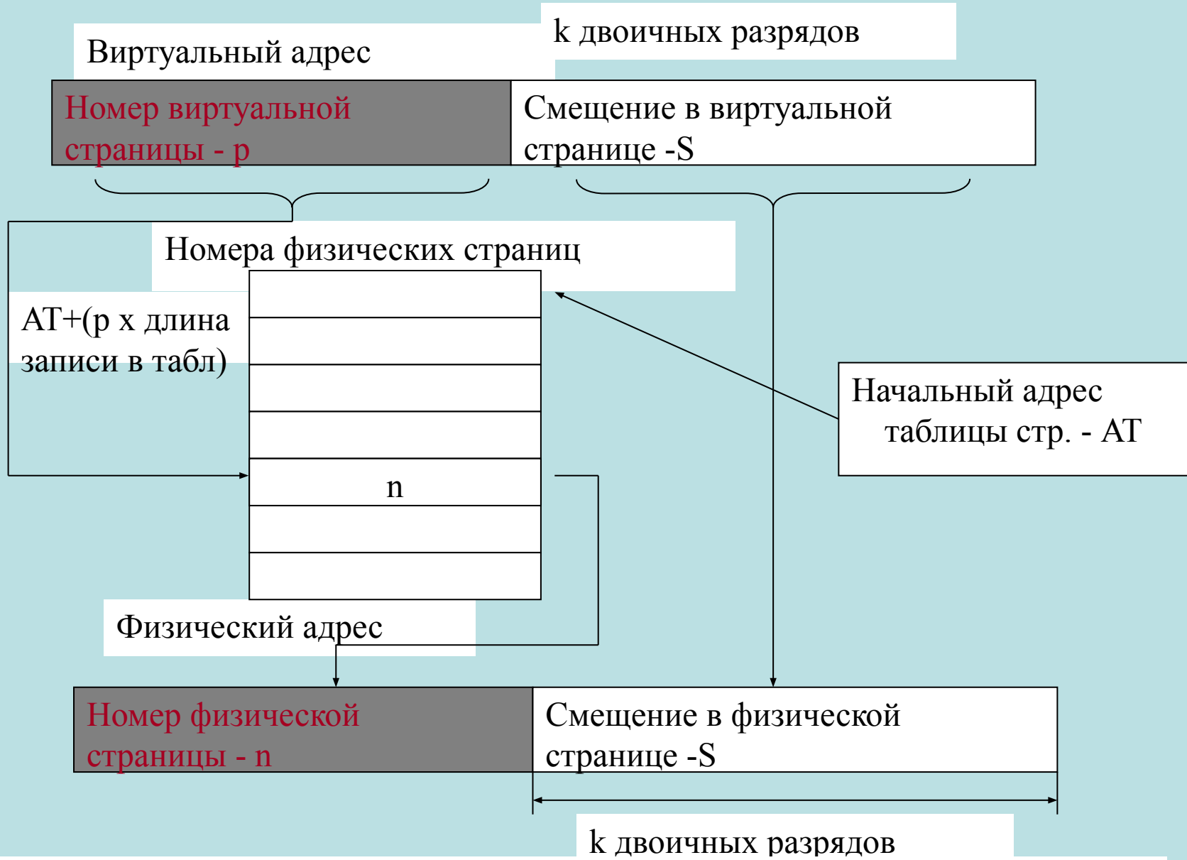
Схема преобразования виртуального адреса в физический при страничной организации памяти
