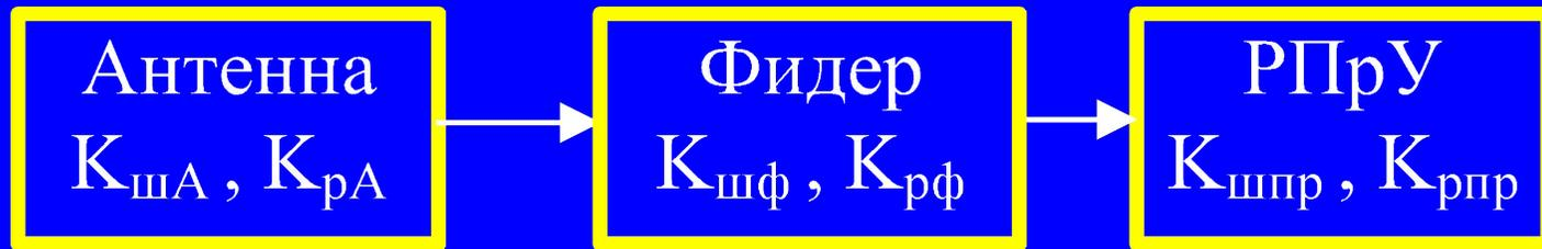
$$K_{ш\Sigma} = K_{шА} + \frac{K_{шф} - 1}{K_{pA}} + \frac{K_{шпр} - 1}{K_{pA} K_{pф}} = 1 + \frac{T_A}{T} + \frac{1}{K_{pф}} - 1 + \frac{K_{шпр}}{K_{pф}} - \frac{1}{K_{pф}} = \frac{T_A}{T} + \frac{K_{шпр}}{K_{pф}}$$
