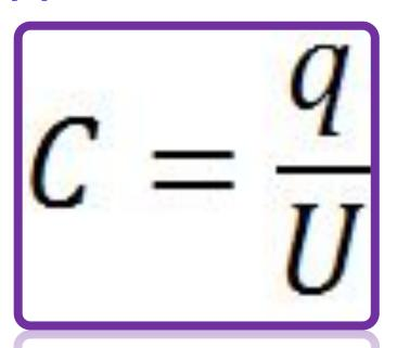
При постоянном заряде электроемкость и напряжение обратно пропорциональны друг другу.
