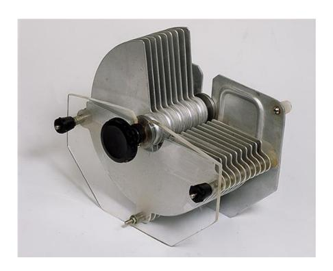
Система двух проводников, разделенных тонким слоем диэлектрика, называется конденсатором.
