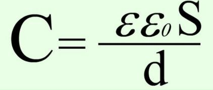
С – электрическая емкость плоского конденсатора [ Ф ]
