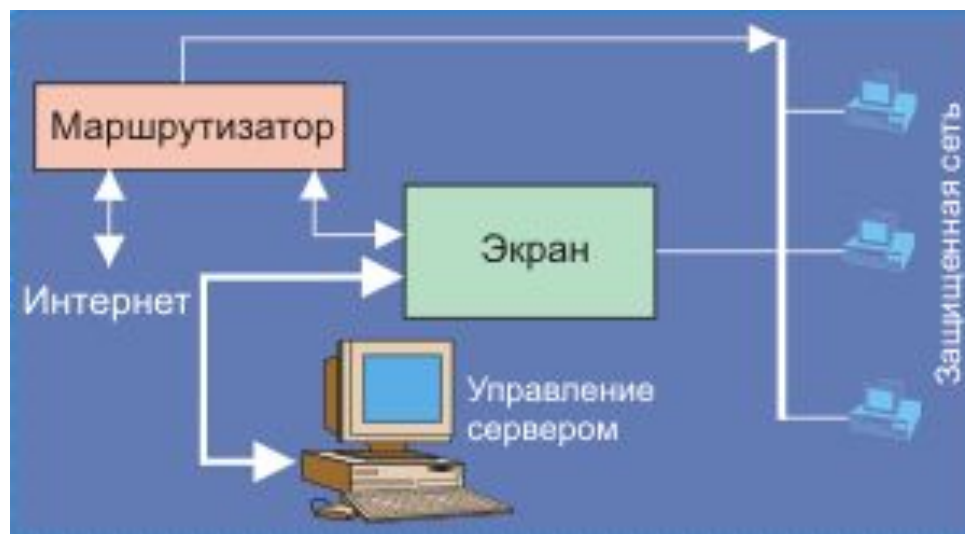
Рис. 5. Схема Firewall, где функцию экрана выполняет маршрутизатор
