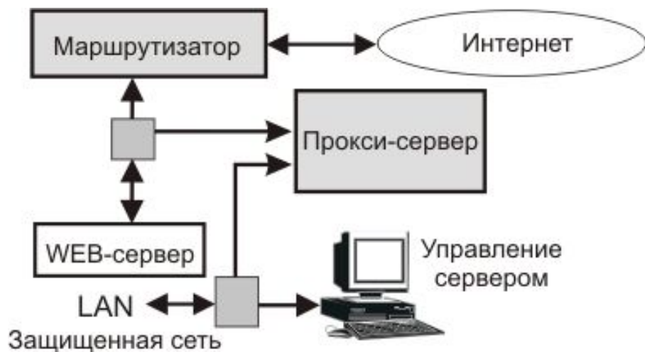
Рис. 6. Размещение WEB-сервера в демилитаризованной зоне
