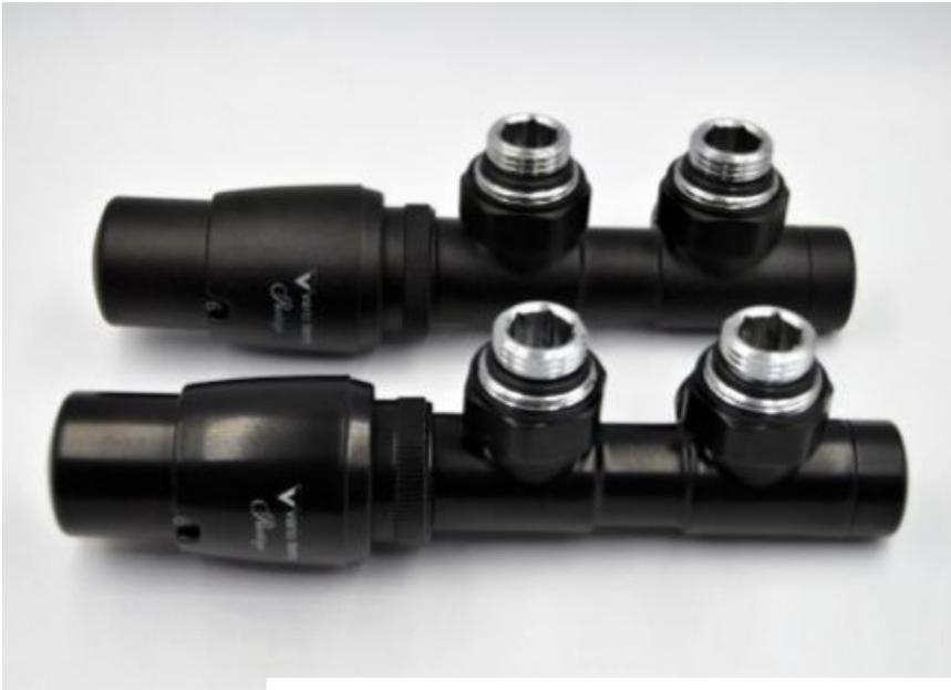
Термостатический узел в комплекте с термоголовкой в цвет арматуры. Техническая особенность узлов серии Twins заключается в расположении термостатического клапана на правой оси или левой. **Сам термоклапан должен располагаться только со стороны оттока (обратки)!**
