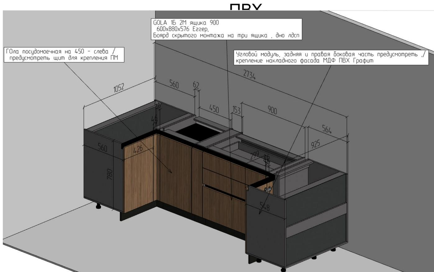
Накладные фасады МДФ ПВХ Графит на полуостров – на усмотрение технолога - можно сделать как часть полуострова – замена боковой и задней части – не больше одного стыка 580мм в нахлест
