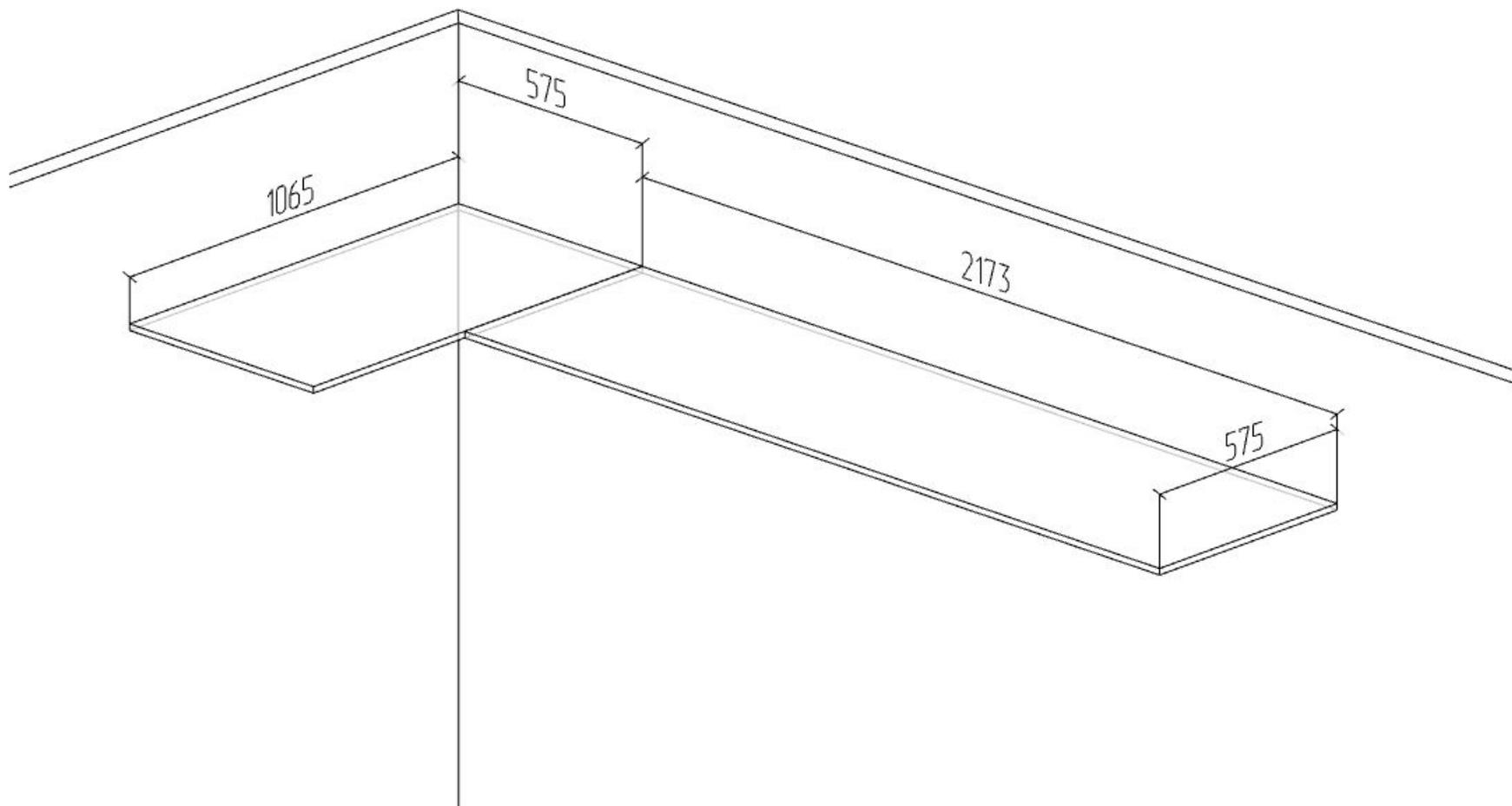
Средний ряд :фасад рефленный высотой 658 мм , корпус 645 мм ; глубина 301мм; задняя стенка в паз ; припуск фасада относительно корпуса -14мм; высота от пола по корпусу 1499-1500мм
