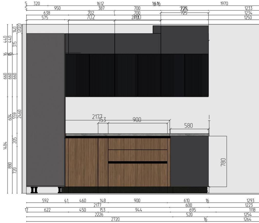
Вид слева. 1052мм-это размер модуля плюс отступ от стены, размер столешницы в отдельном слайде
