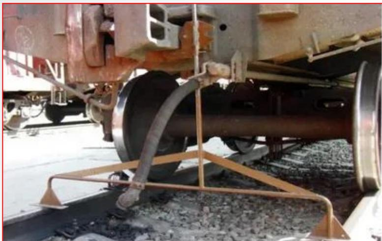
Измерение высоты автосцепки над уровнем головок рельсов
