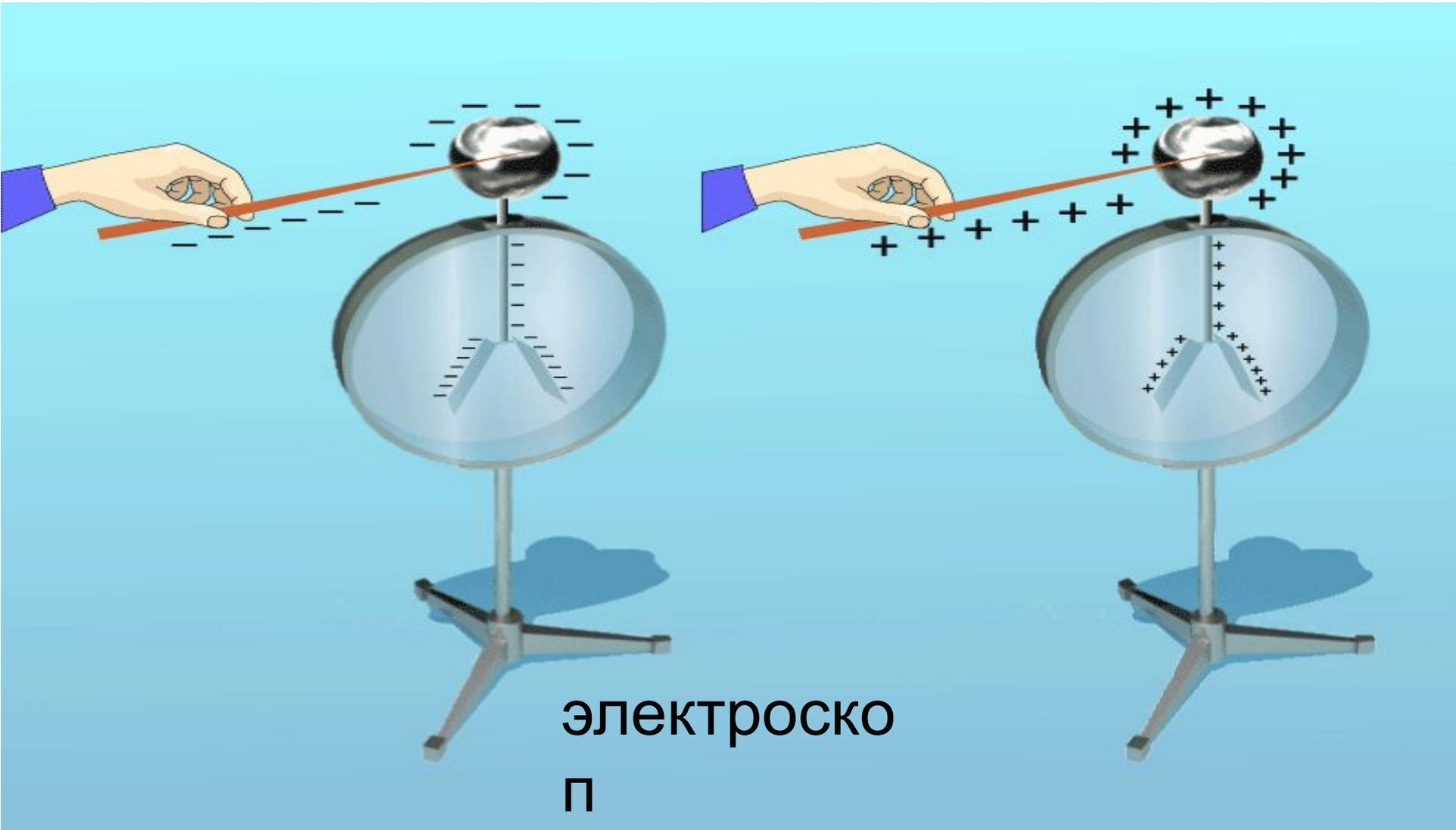
Принцип действия электроскопа,
