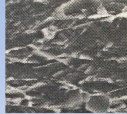
2- Начало рекристаллизации в холоднодеформированной стали 10пс – образование зародышей рекристаллизации (ЗР).
