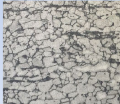
4 – Завершение рекристаллизации в холоднодеформированной стали 10 пс.
