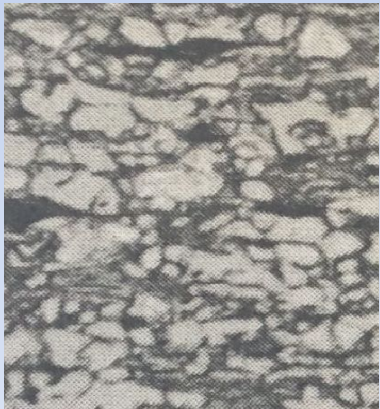
3- Развитие рекристаллизации в холоднодеформированной стали 10пс – образование новых зародышей рекристаллизации и их рост.
