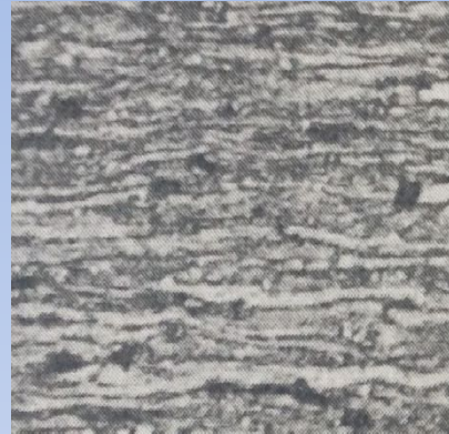
2- Начало рекристаллизации в холоднодеформированной стали 10пс – образование зародышей рекристаллизации (ЗР).
