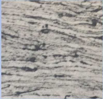
1- Структура холоднодеформированной стали 10пс.
