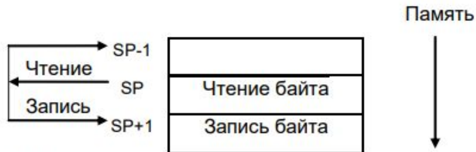
Рис. 3.3. Содержимое указателя стека при записи и чтении данных
