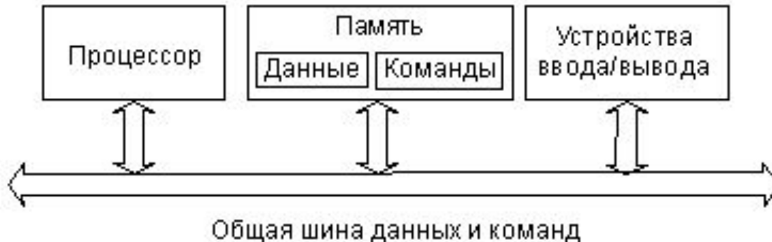
Рис. 3. Архитектура с общей шиной команд и данных
