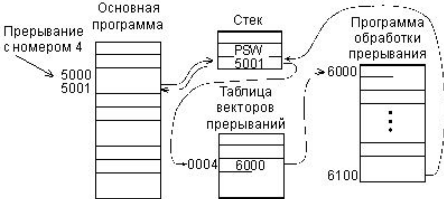
Рис. 10. Упрощенный алгоритм обработки прерывания
