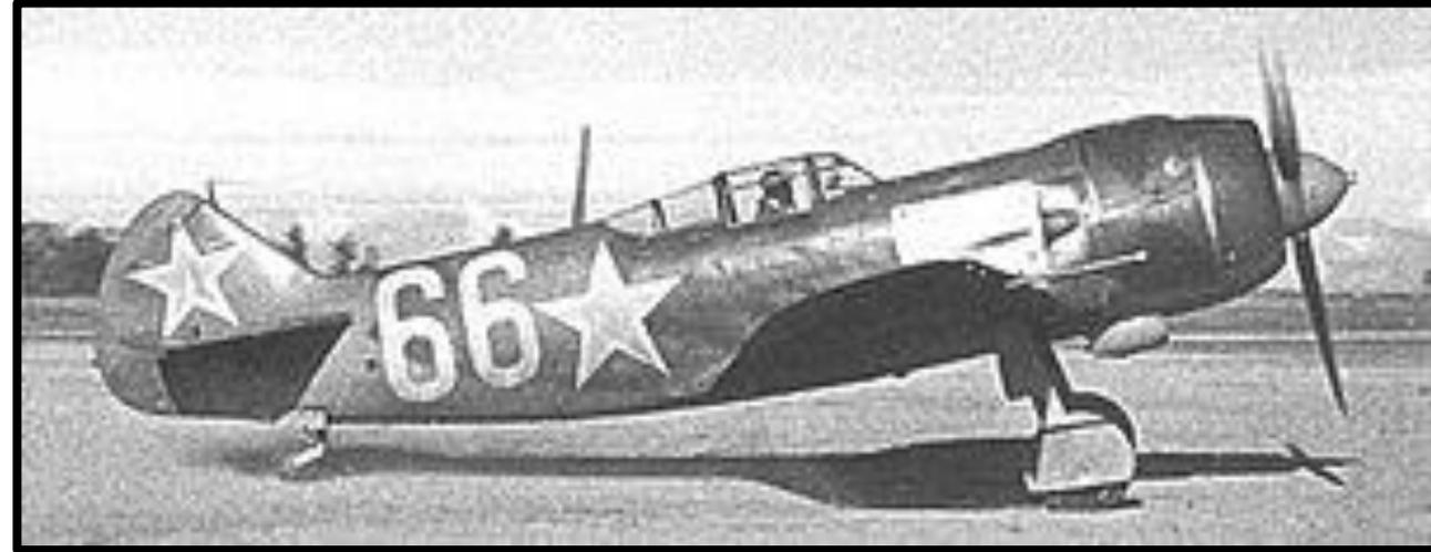
**Ла-5** — одномоторный истребитель созданный ОКБ-21 под руководством С. А. Лавочкина в 1942 г. в г. Горьком. Самолёт представлял собой одноместный моноплан цельнодеревянной конструкции с убирающимся шасси и закрытой кабиной. Первоначальное название — ЛаГГ-5.
