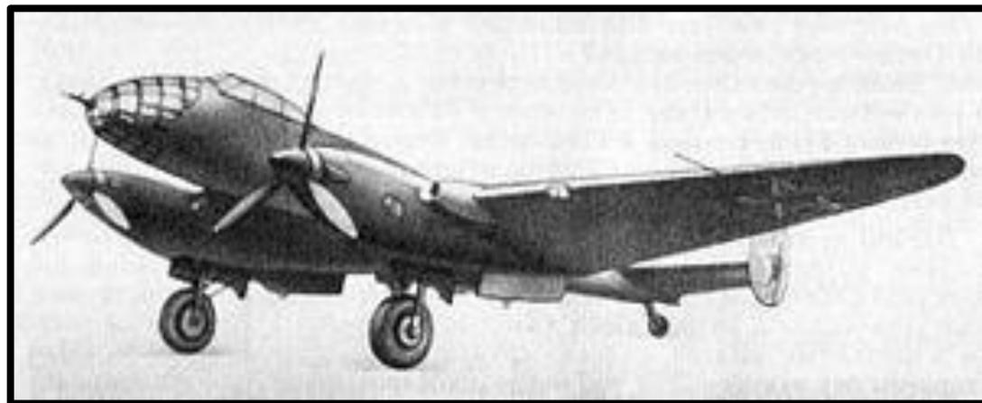
**БР-2 (ДБ-240)** — дальний бомбардировщик, двухмоторный моноплан с крылом типа «обратная чайка». Самолёт спроектирован в ОКБ-240 под руководством В. Г. Ермолаева
