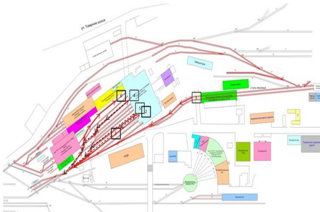
Рисунок 4 – Перемещение тепловозов 2ТЭ116, 2ТЭ116У по технологическим позициям с указанием реперных точек при выполнении ТО-3 и ТР-1
