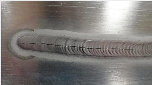
Продольная холодная трещина
