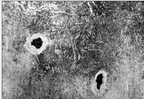
Вольфрамовые включения на макрошлифе
