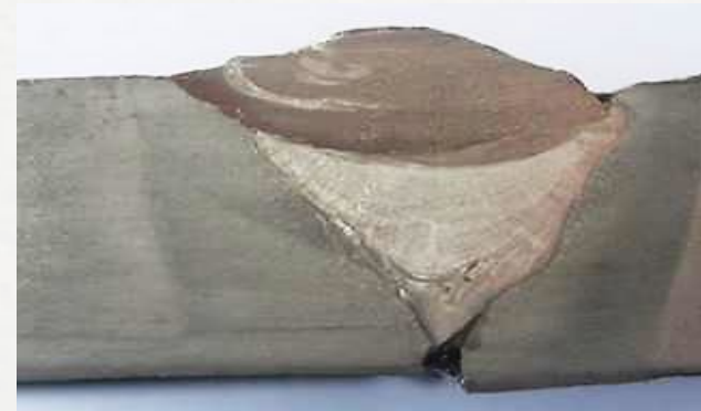
Непровар в корне стыкового сварного шва
