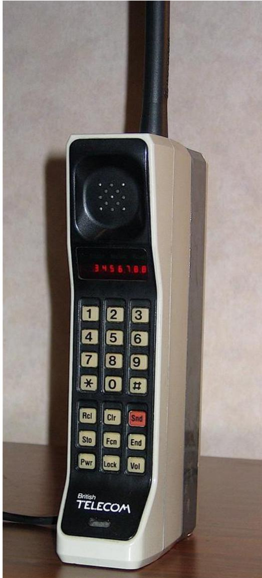
Испытания первого сотового телефона состоялось 3 апреля 1973 года. Для этого на 50-этажном здании в Нью-Йорке была смонтирована первая базовая станция. Она могла обслужить до 30 абонентов. Сам первый сотовый телефон, созданный Мартином Купером, назывался DynaTAC и весил 1,15 кг. На его передней панели располагались 12 клавиш, 10 из которых были цифровыми, а две — для вызова и прекращения разговора. Ни дисплея, ни дополнительных функций не было.
