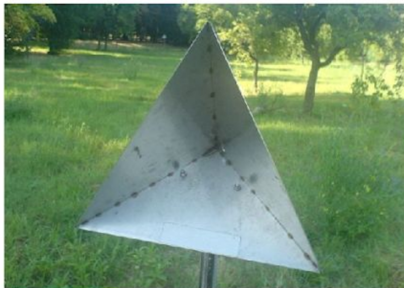
Рис. 4. Угловой отражатель: принцип действия и внешний вид.
