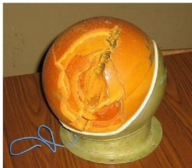
Рис. 5. Линза Люниберга: принцип действия и внешний вид «в расколе» (после воздействия поражающих элементов ЗУР).
