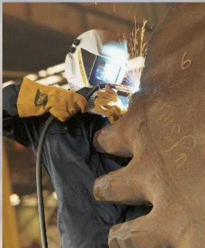
Полуавтоматическая сварка в защитном газе. Подача сварочной проволоки автоматизирована. Сварщик управляет сварочной головкой.
