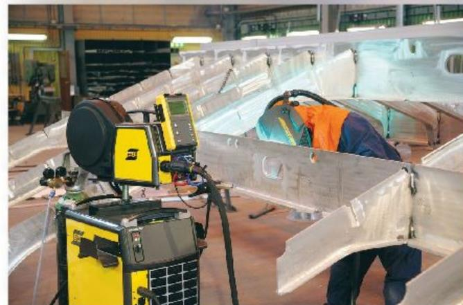
Сварка рамы и кузова автобуса
