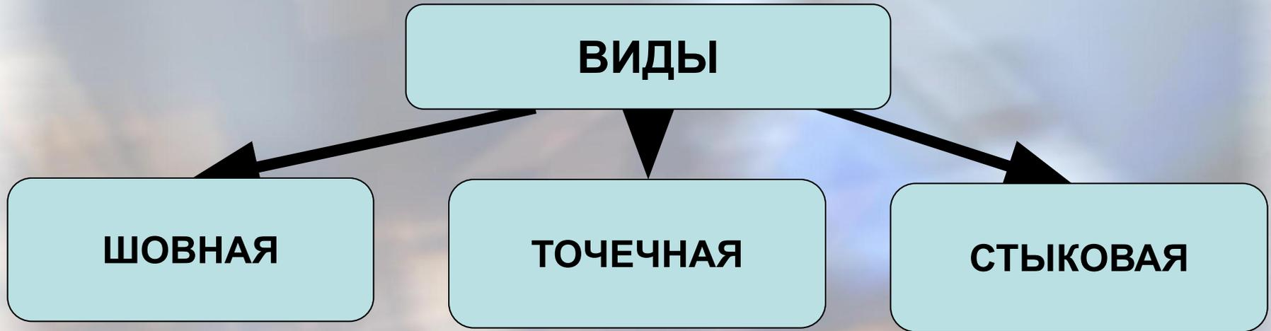
**контактная сварка — процесс образования неразъемных соединений в результате нагрева металла проходящим электрическим током и пластической деформации зоны соединения под действием сжимающего усилия.**
