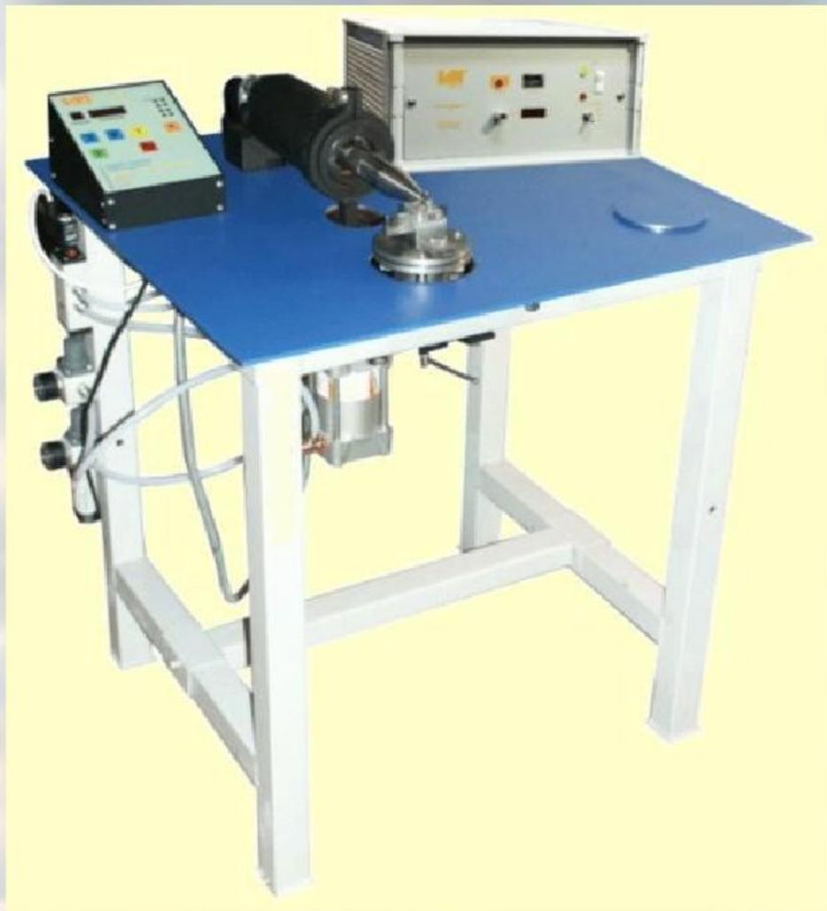
**Ультразвуковая сварочная установка**
