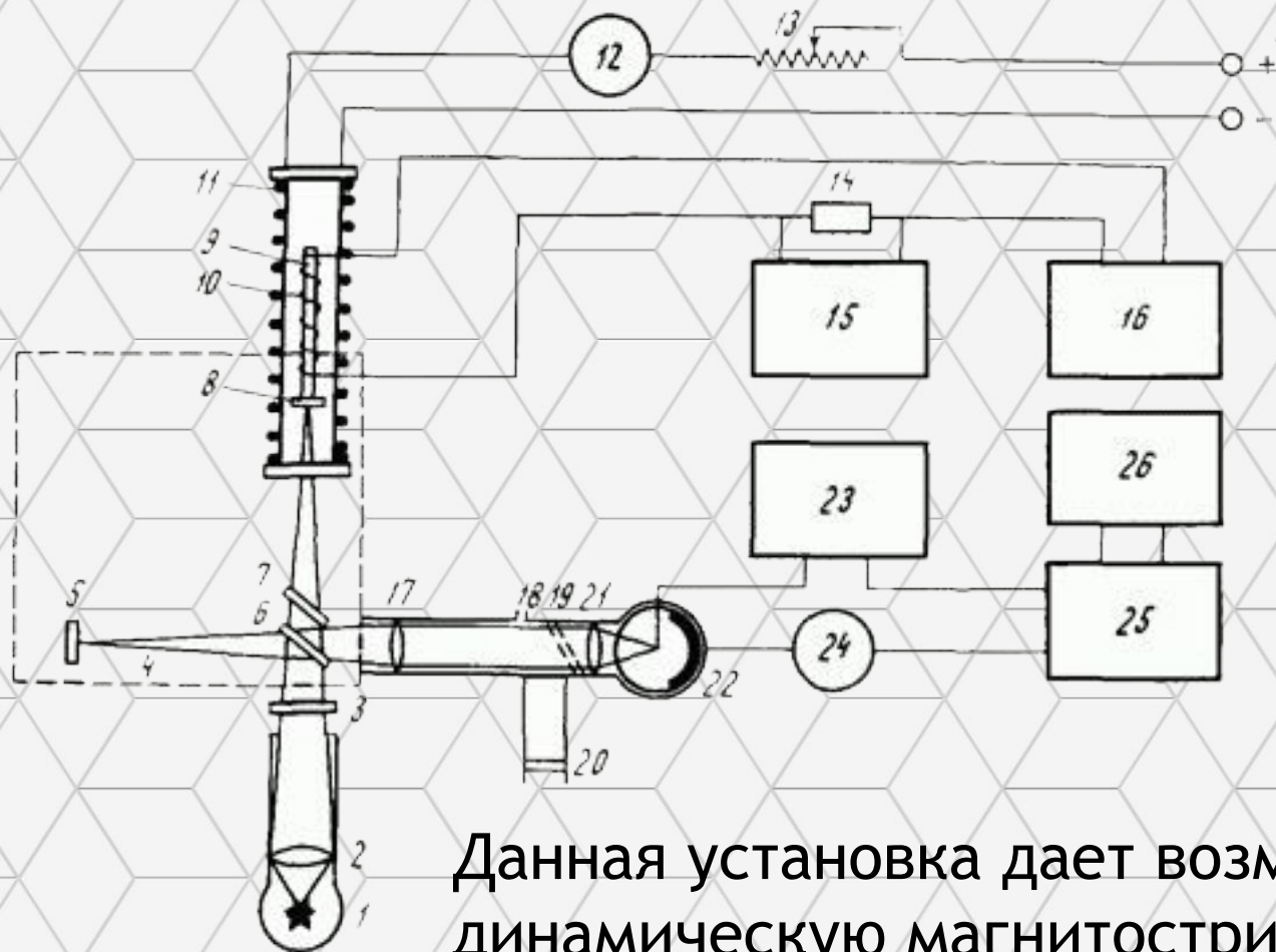
Рис. 68. Схема интерференционной установки для измерения динамической магнитострикции: 1 — источник света, 2 — линза, 3 — светофильтр, 4 — интерферометр, 5, 8 и 19 — зеркала, 6 и 7 — плоскопараллельные стеклянные пластинки, 9 — исследуемый образец, 10 и 11 — катушки, 12 — амперметр, 13 — реостат, 14 — сопротивление, 15 — ламповый вольтметр, 16 — звуковой генератор, 17 и 21 — линзы, 18 — щель, 20 — экран, 22 — фотоумножитель, 23 — источник питания, 24 — микроамперметр, 25 — селективный приемник, 26 — осциллограф
