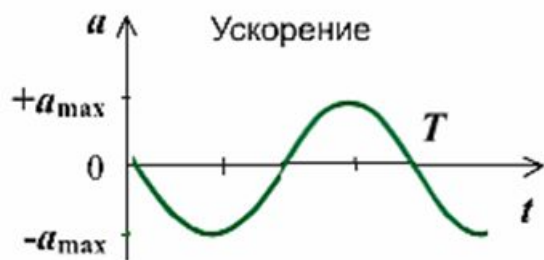
Графики смещения, скорости, ускорения при гармонических колебаниях
