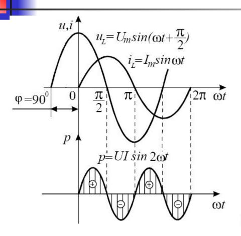
Мгновенная мощность на индуктивном элементе имеет только переменную составляющую изменяющуюся с двойной частотой ω тока и напряжения.
