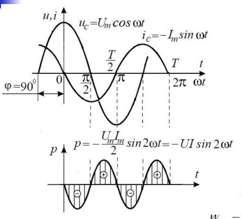
Мгновенная мощность на ёмкостном элементе имеет только переменную составляющую изменяю-щуюся с двойной частотой ω тока и напряжения.
