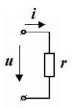
Электрическое сопротивление - параметр элемента электрической цепи характеризует свойство элемента преобразовывать электрическую энергию в другие виды энергии
